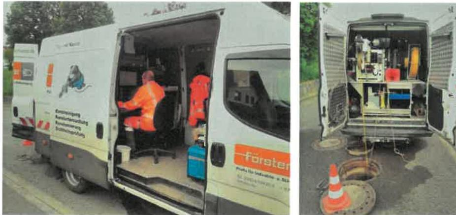
Die Inspektion erfolgte nach DIN-EN 13508-2, die Erfassung und Auswertung der Schäden erfolgt nach den nationalen Festlegungen Arbeitshilfen Abwasser durchgeführt und im Austauschformat ISYBAU-xml.
